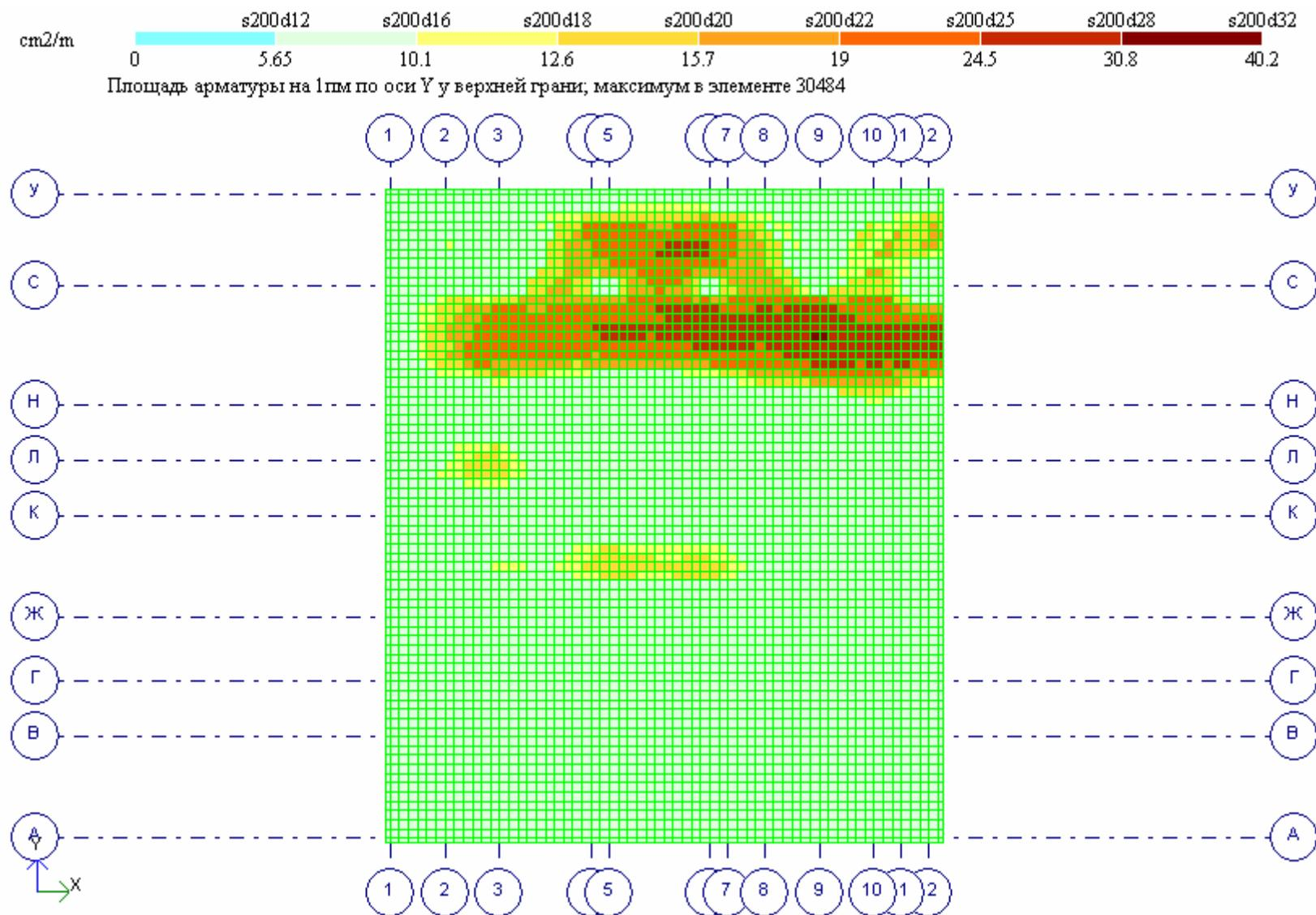
Рис. 3.4. Армирование фундаментной плиты
